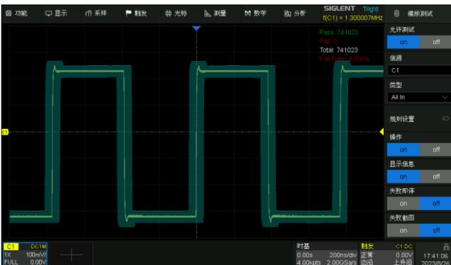
基于硬件的模板测试功能，最高每秒可执行 80000 次测试。根据用户自定义的垂直和水平容限生成模板，比较被测信号是否触碰模板，如果被测信号触碰模板则测试失败，可以预先设定测试失败时采集停止以及蜂鸣器告警，将失败帧自动截图，适用于长期无人值守监测异常信号
