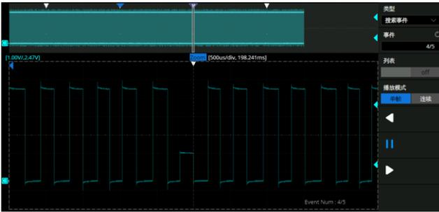
通过指定条件，对一帧波形进行自动搜索，并把符合条件的事件标识出来。结合导航功能，快速地定位到感兴趣的事件，然后借助示波器的分析功能对事件进行详细的分析，省去了手动搜索的耗时和不便。导航可以对搜索事件导航，也可以对时间和历史帧导航
