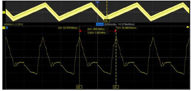
最大100 Mpts/通道的深存储，使用户能够使用更高的采样率捕获更长时间的信号，结合水平和垂直方向上的缩放功能，做到整体与细节的兼顾
