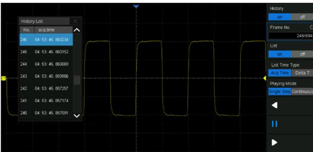
最大可记录 80000 帧波形；自动实时录制，随时可回放历史波形观察异常事件，并通过光标或测量参数快速定位问题来源；可录制模板测试的失败帧
