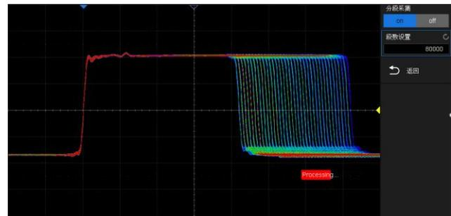
分段采集将波形储存空间分成多段，每段空间存储一个触发帧，最大可以采集 80000 个触发事件，在 Sequence 周期内可最大限度地降低触发事件之间的间隔时间（小至 2μs），提高对异常事件的捕获概率。Sequence 模式下采集的所有波形段可以一次性全部映射到屏幕上，也可以通过 History 进行单帧回放
