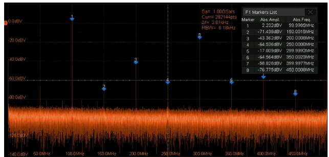
通过硬件加速的 FFT 功能，最大运算点数为 2M 点，在提供优越的频谱分辨率的同时，仍然能够保持较高的频谱刷新率。支持多种窗函数，支持普通、平均、最大值保持等模式，支持自动标记峰值点
